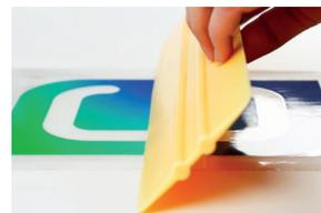
3 - Entfernen Sie die Schutzfolie vom Tape. Bringen Sie das Tape vorsichtig auf das gedruckte und getrocknete Design auf.
